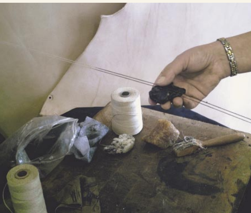
Nadel und Faden: Der Faden muss die richtige Faserlänge haben, um nicht vor der Zeit zu reißen. Er wird vor dem Nähen mit Pech und Wachs versetzt,
