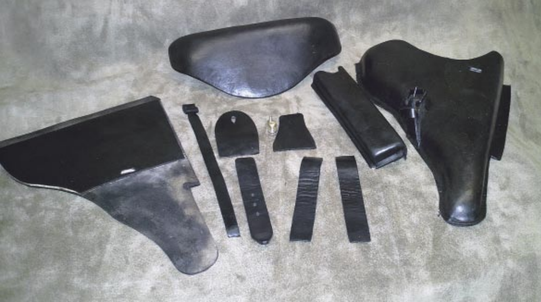
Deko-Teilesatz: Die Einzelteile einer (neuen) Pistolentasche 08 sind fertig geschnitten, geschärft und zum Vernähen bereit. Zum Erneuern einer Hebenschlaufe muss die gesamte Tasche zerlegt werden.
